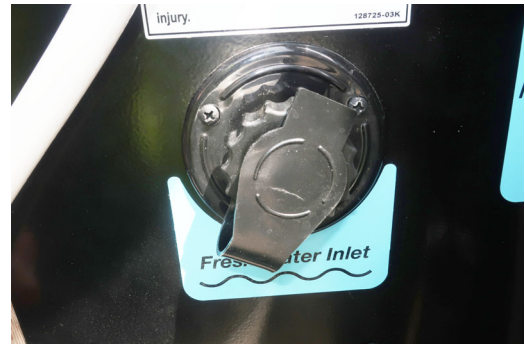
Tank Fill Inlet
